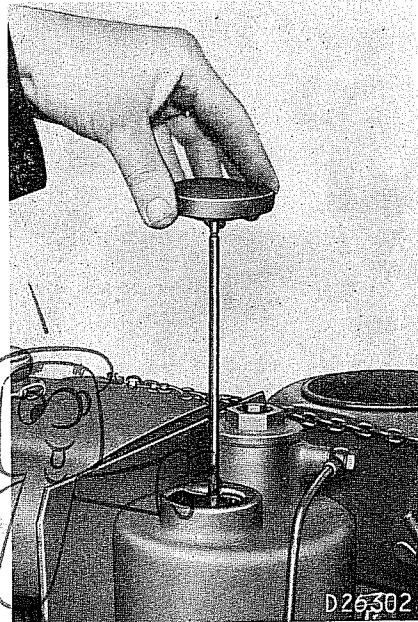
Kontrolle des Schmierölstandes
