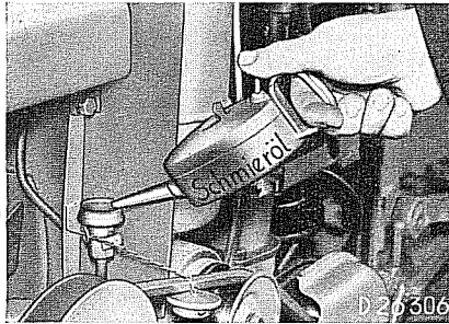
Öl für Pumpenantrieb einfüllen
